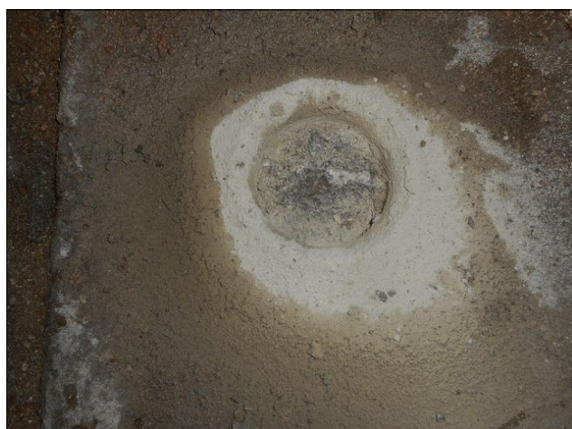
foto /18/ Pohled na odběr vzorků z podlahy suterénu S12
